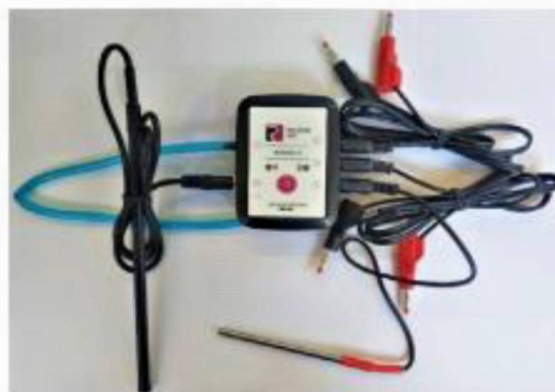
Рис. 9. Беспроводной мультитатчик Releon Air «Физика-5»
