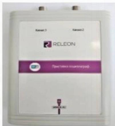
Рис. 32. Двухканальная приставка-осциллограф
